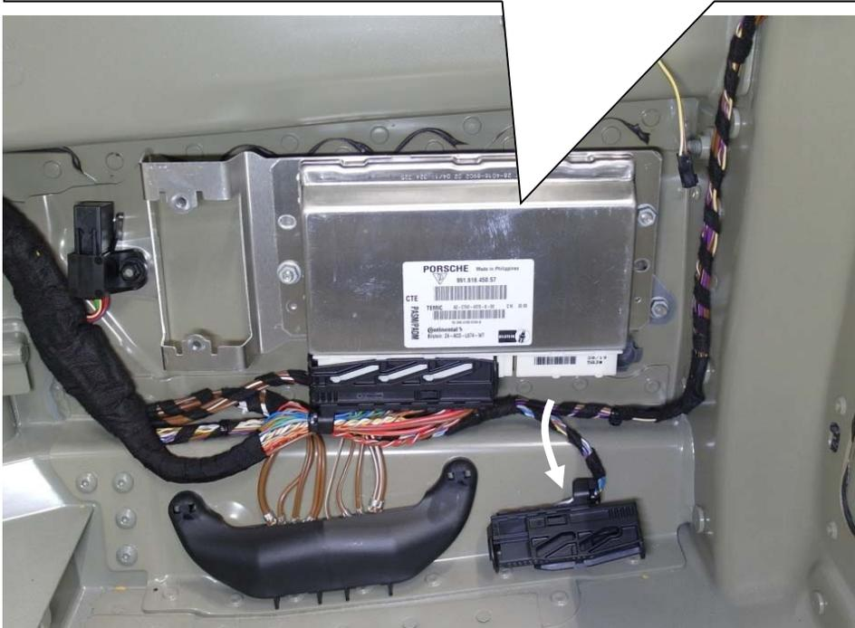
Mitgelieferten Stecker in das Steuergerät einstecken und verriegeln.
